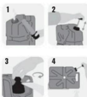
**Uso del grifo:** Girar el grifo en sentido horario y bloquear en posición para un caudal sostenido de agua o presionar y mantener el grifo para un chorro de agua instantáneo.
