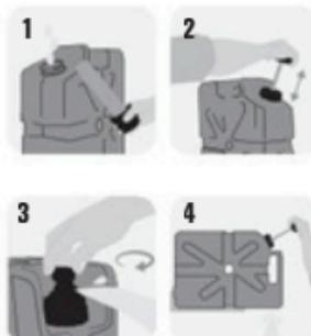
**Verwendung des Wasserhahns:** Drehen Sie den Wasserhahn im Uhrzeigersinn und rasten Sie ihn ein, um einen anhaltenden Wasserfluss zu erzielen, oder drücken Sie den Wasserhahn herunter für einen sofortigen Wasserstoß. Um den Wasserhahn zu lösen, drehen Sie ihn gegen den Uhrzeigersinn
