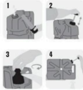
**Utilisation du robinet:** Tourner le robinet dans le sens des aiguilles d'une montre et le verrouiller en position pour maintenir le débit d'eau, ou appuyer et maintenir le robinet en position basse pour un jet d'eau instantané.
