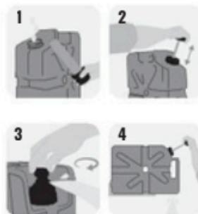
**Utilizzo del rubinetto:** ruotare il rubinetto in senso orario e bloccarlo in posizione per un flusso d'acqua continuo oppure premere e tenere premuto il rubinetto per un getto d'acqua immediato. Per sbloccare il rubinetto, ruotare in senso antiorario.
